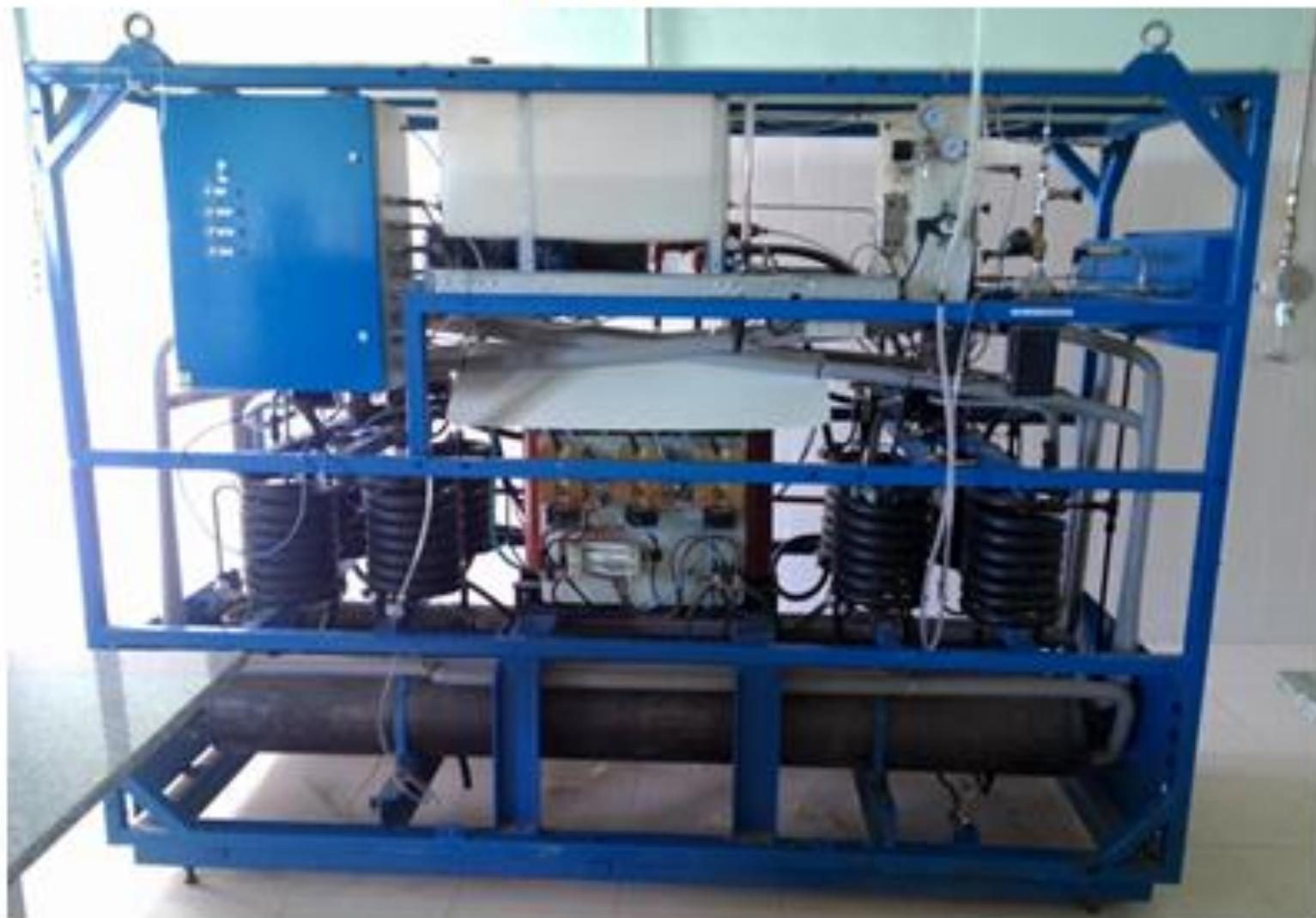
Electrolisis de Agua/Capacidad Max. 4NM<sub>3</sub>H<sub>2</sub>/Presión hasta 30 Bar
