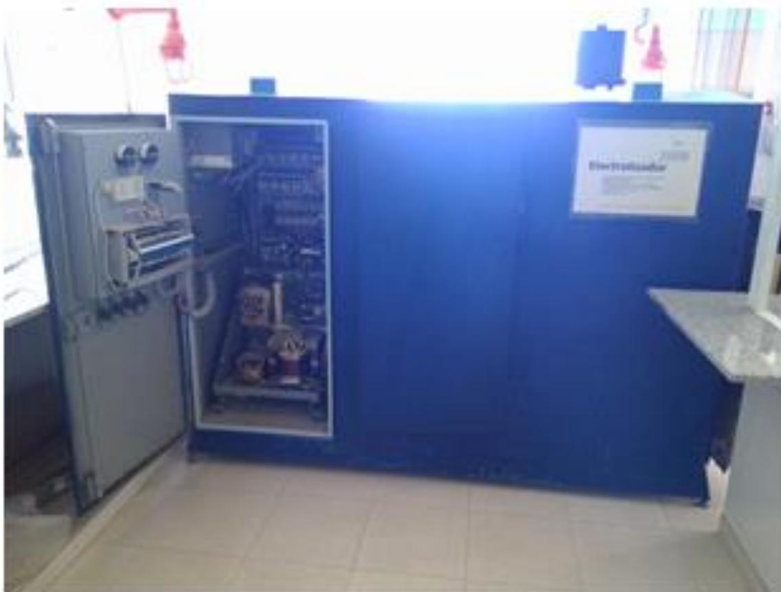
Capacidad Máx. hasta 1 NM<sup>3</sup>H<sub>2</sub> – Cedido por el Laboratorio de Hidrógeno de la Universidad de Quebec a Trois Rivieres, a cargo del Prof. Tapan K. Bose (2002), para el arranque de la Planta Demostrativa de Hidrógeno en Pico Truncado, Santa Cruz, Argentina.
